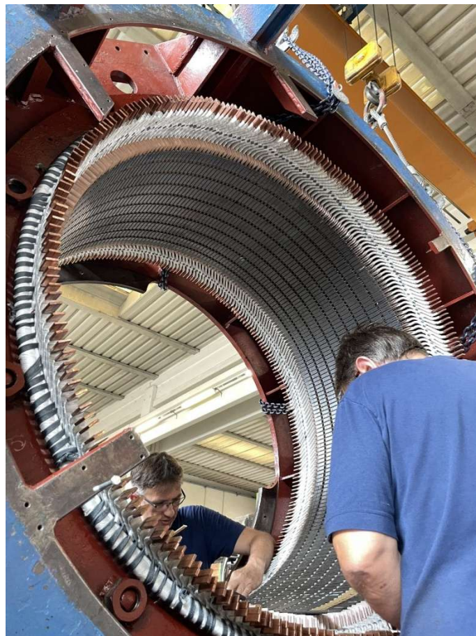
Figura 6: Revisione + riavvolgimento alternatore Marelli per centrale idroelettrica, coppia 22000Nm.
