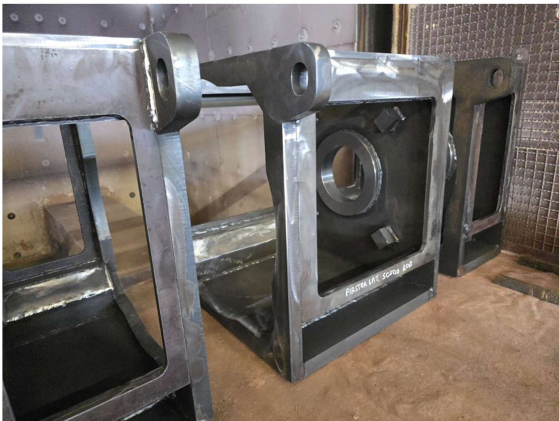
Figura 18: Chiusure motore DC, trattamento di distensione.
