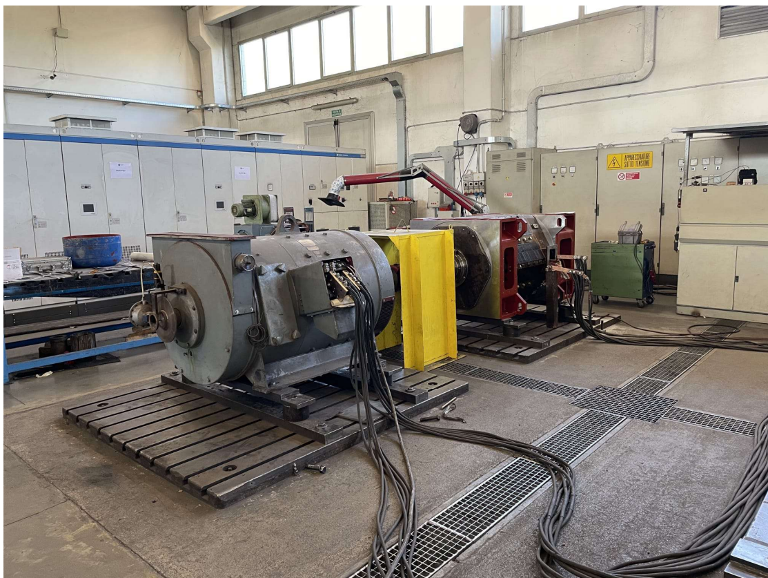
Figura 23: Prova, caratteristica a carico motore DC costruito internamente.
