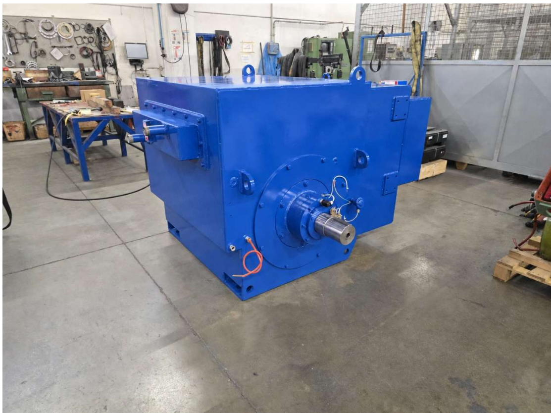
Figura 11 e 12: Progettazione e costruzione motore AC per gabbia di laminazione, coppia 5000 Nm.
