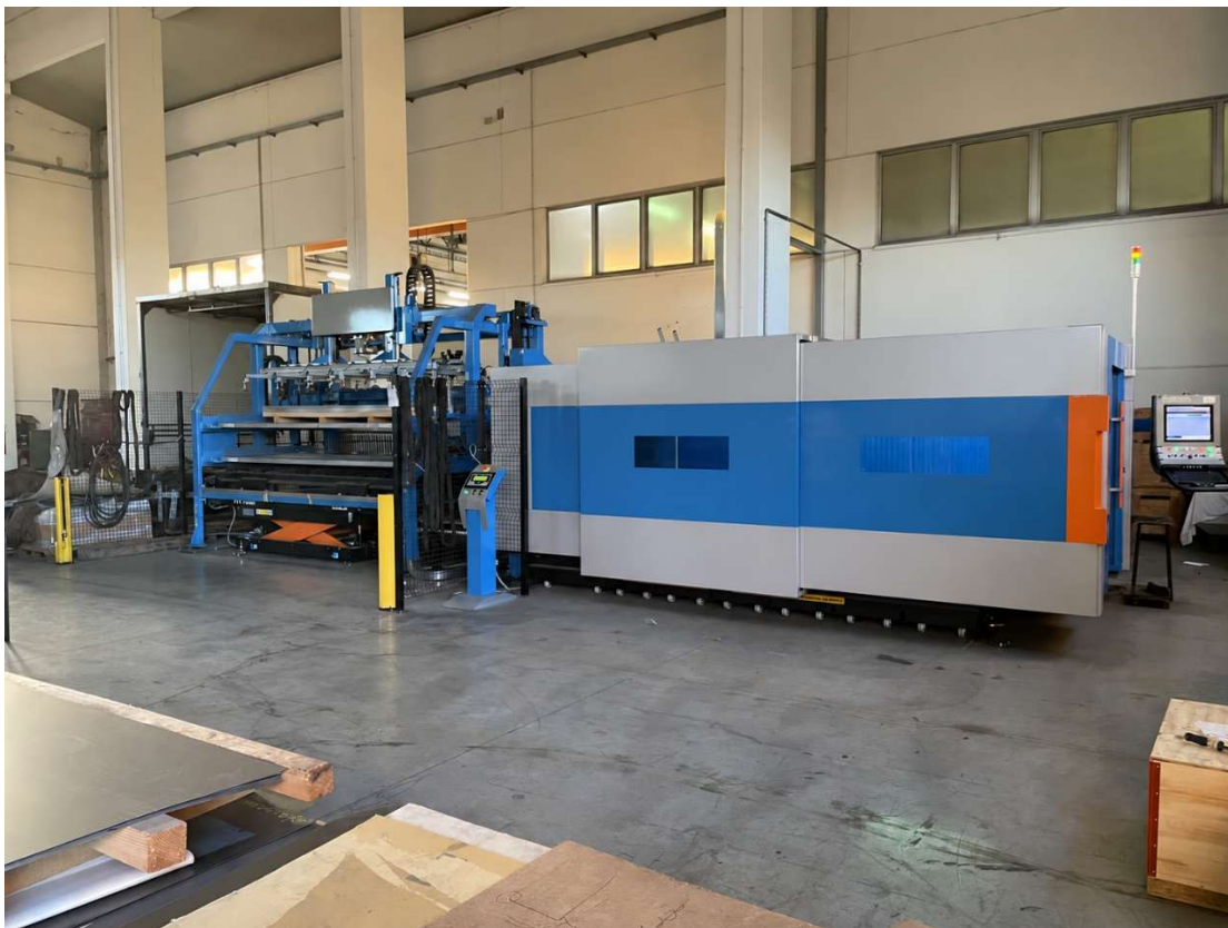
Figura 7: Laser Genius con tecnologia taglio in aria compressa.
