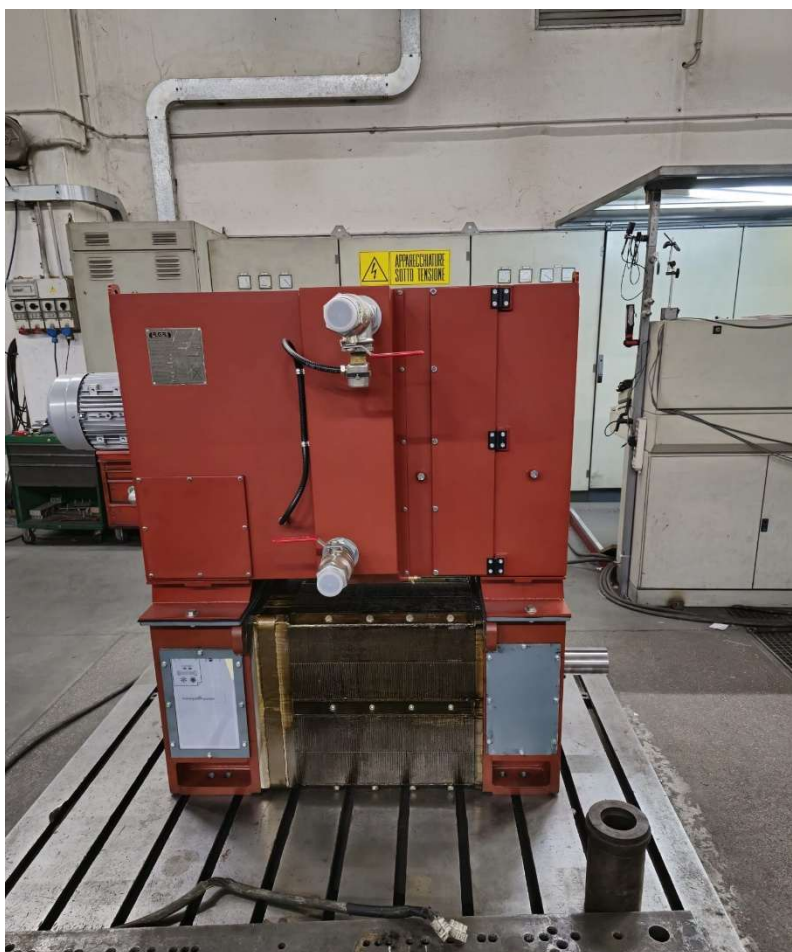
Figura 15: Motore DC taglia 315 per gabbia e sbozzatura, coppia 3900Nm.
