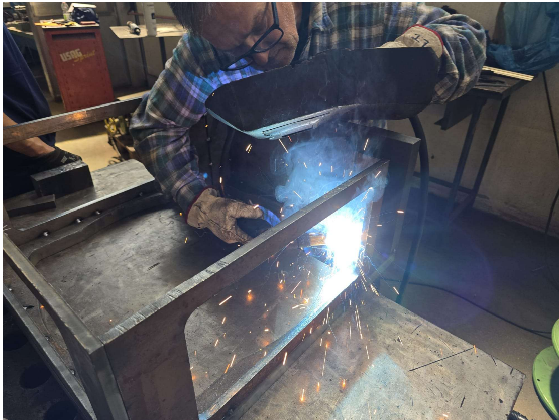
Figura 17: Esecuzione chiusure per motore DC.
