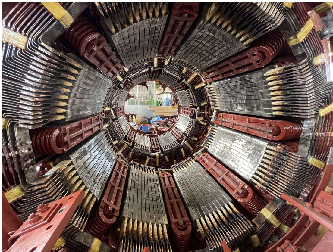
Figura 4: Revisione + riavvolgimento motore di gabbia tipo tandem Westinghouse, coppia 35.5 kNm.
