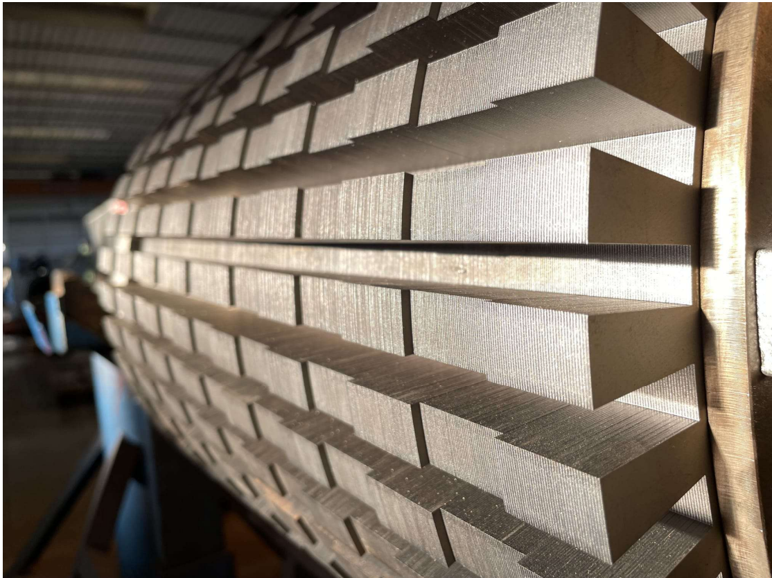
Figura 19: Impaccaggio rotore DC.
