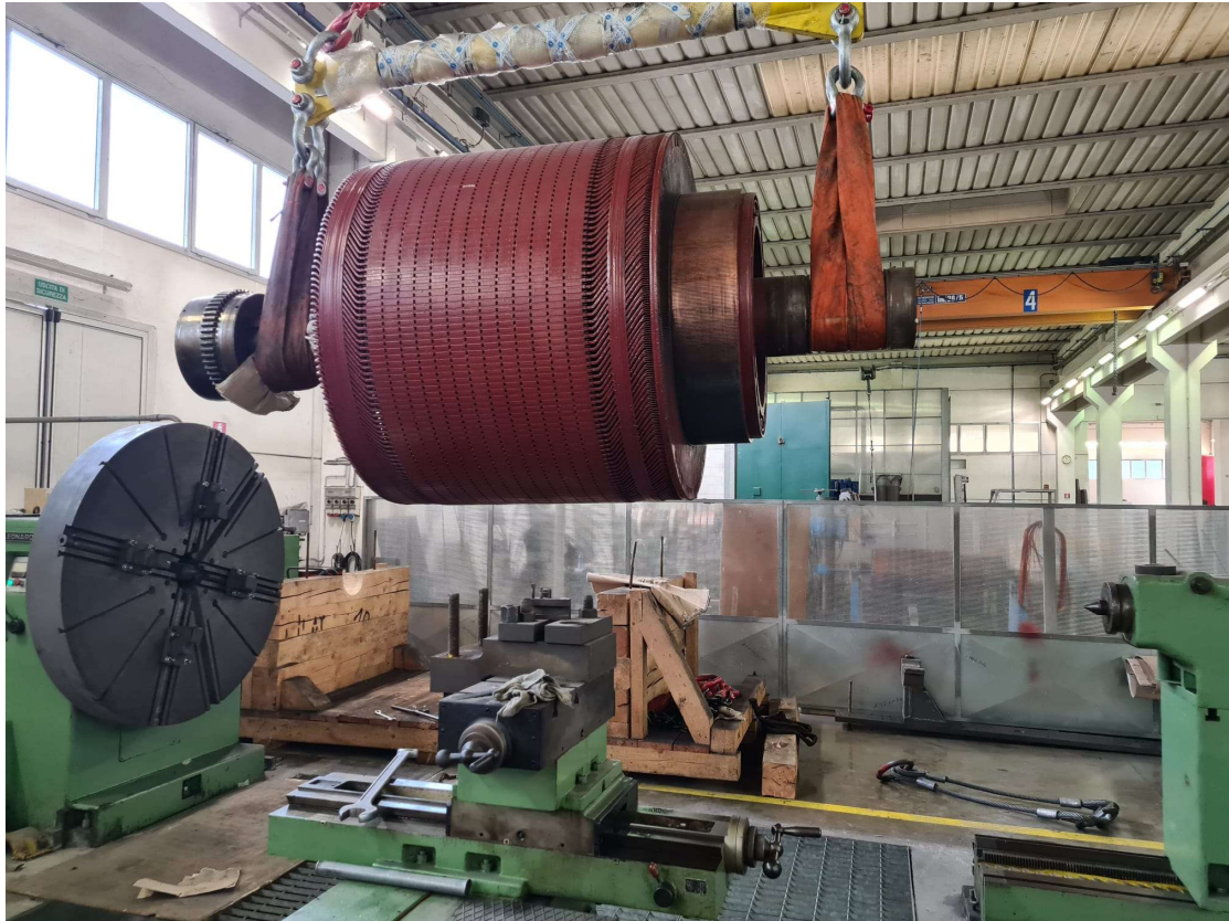
Figura 25: Revisione motore Ge.Co. Westinghouse durante una fermata estiva.
