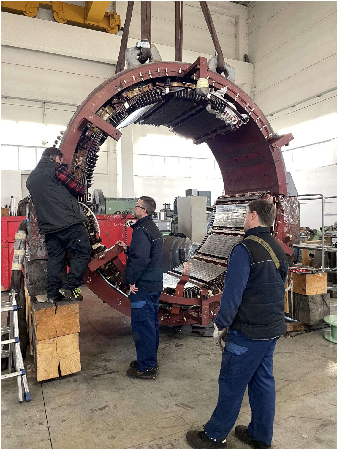
Figura 1: Revisione + Riavvolgimento statore motore MCF, coppia 555kNm.
