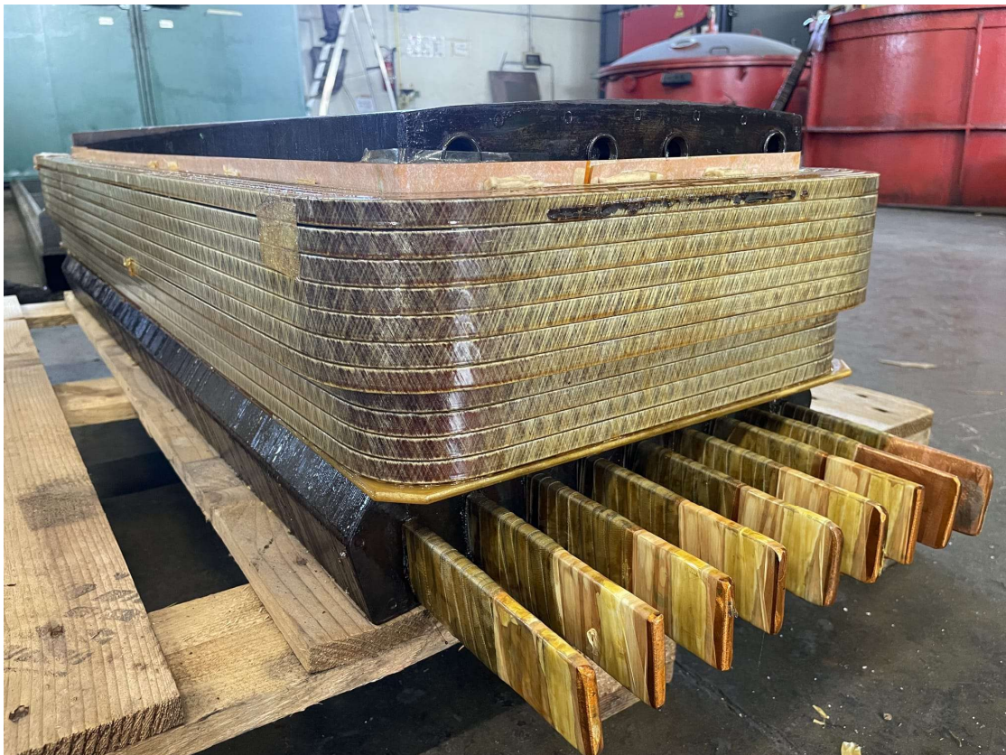
Figura 20: Reverse engineering per costruzione ricambio polo principale per motore DC a semi-statori ASEA.
