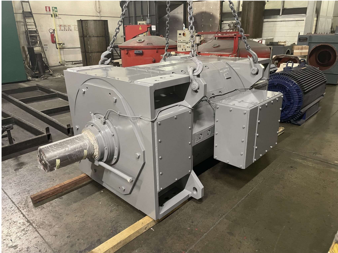
Figura 5: Progettazione e costruzione motore DC taglia 560 per gabbia di laminazione, coppia 15000Nm.
