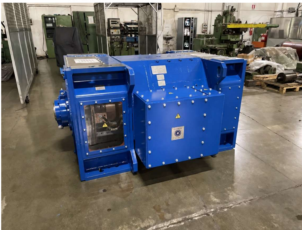
Figura 2: Progettazione e costruzione motore DC taglia 500 per estrusore, coppia 10500Nm.
